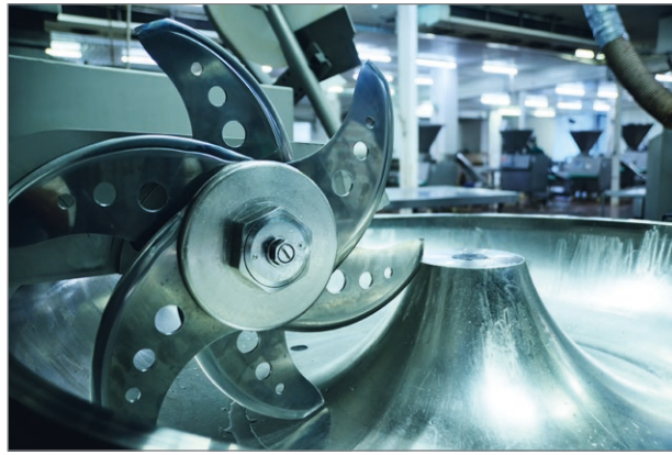
Abb. 4: In Metzgereien werden Kutter oder Cutter beispielsweise zur Herstellung von Wurst verwendet
