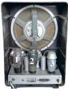
Abb. 2: „Volksempfänger VE 301 Wn von innen (Röhren mit Zahlen markiert)“ 17
